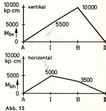
Abb. 15 zeigt die daraus berechneten Biegemomentenkurven.
